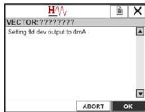
Рисунок 5-34: Настройка значения выходного сигнала 4 мА
