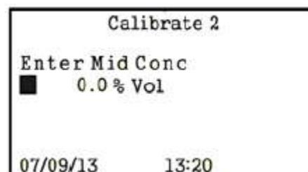
Рисунок 5-5: Ввод значения концентрации среднего поверочного газа
