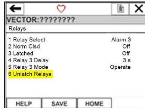
С помощью клавиши прокрутки вниз выберите функцию Unlatch Relay (Реле без механической блокировки). Реле вернется к своей нормально открытой конфигурации.
