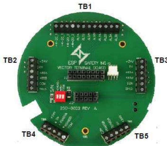
Рисунок 4-9: Клеммная колодка
