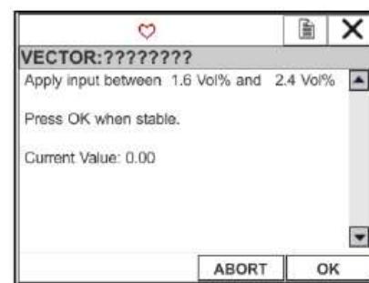
Рисунок 5-21: Калибровка поверочным газом
