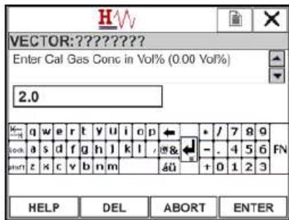
Рисунок 5-22: Ввод данных по концентрации поверочного газа
