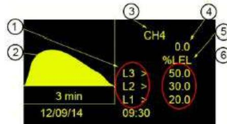
Рисунок 4-2: Одинарный дисплей для отображения информации по газу
