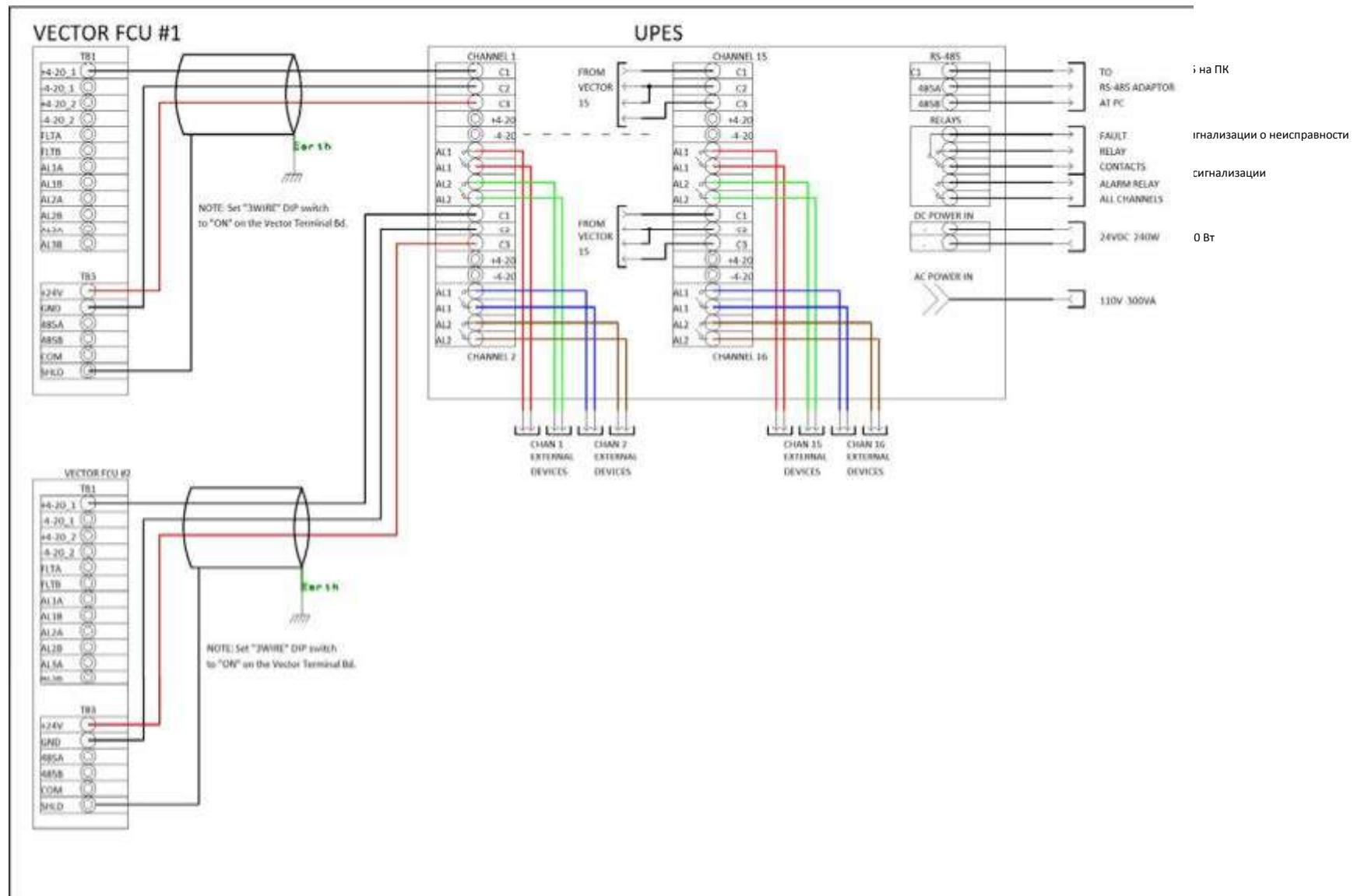
**Приложение 2 – Схема калибра проводов для блока Vector с преобразователь ПГУ-903У****Схема калибра проводов для блока Vector с УДАЛЕННЫМ преобразователем ПГУ-903У**
