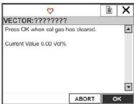
Рисунок 5-17: Выход из режима нулевой калибровки
