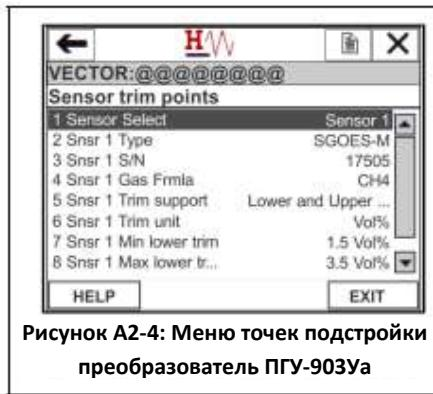
Рисунок А2-4: Меню точек подстройки преобразователь ПГУ-903Уа
