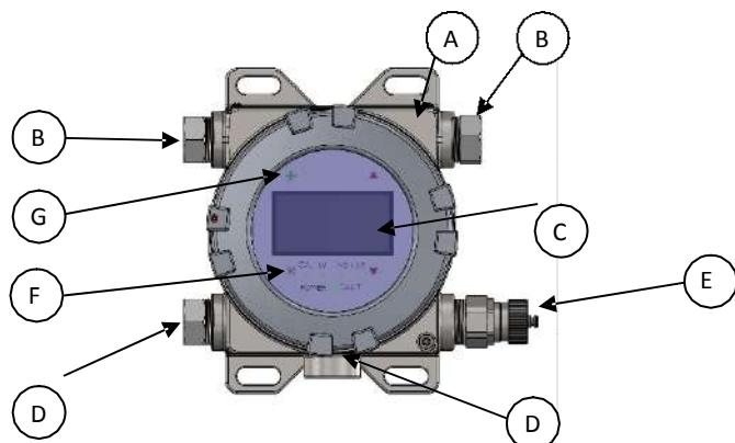
Рисунок 1-2: Компоненты блока управления Vector
