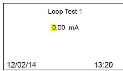
Используйте кнопку Start для перемещения от цифры к цифре и с помощью прокрутки вверх/вниз задайте нужные значения. После установки последней цифры снова нажмите кнопку Start (Пуск), и нужное значение выходного тока появится на реле.
