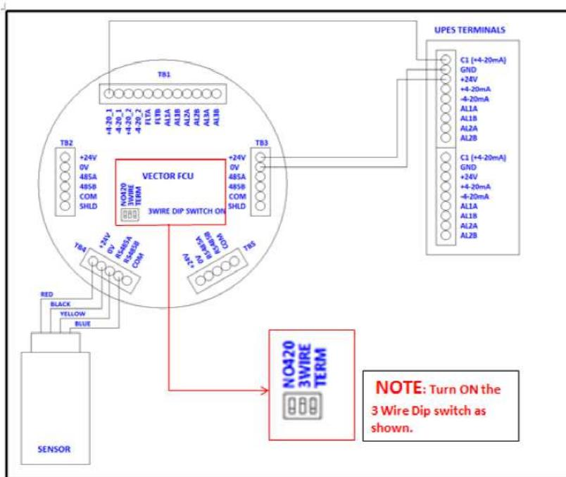
Рисунок 4-11: Подключение газоанализатора Vector ко вторичному устройству S
