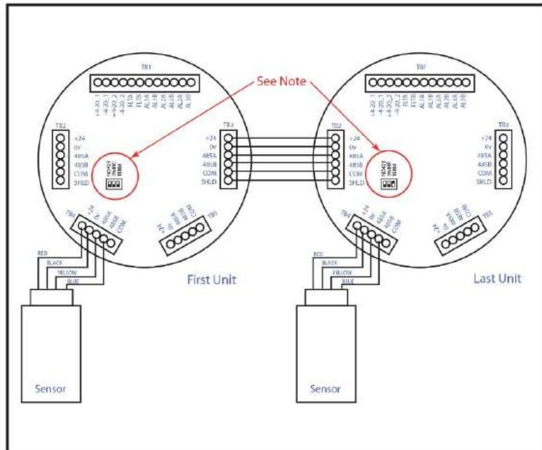
Рисунок 4-14: Подключение газоанализаторов в шлейф по RS-485
