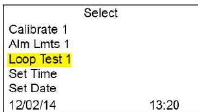
С помощью магнита выберите кнопку Start (Пуск). Для просмотра доступных функций используйте кнопки прокрутки ВВЕРХ/ВНИЗ. Используйте стрелку для прокрутки вниз до функции Loop Test 1 или 2 (Тестирование контура 1 или 2) и нажмите клавишу Select (Выбрать). Если подключен только один преобразователь ПГУ-903У, то функция Loop Test 2 отображаться не будет.
