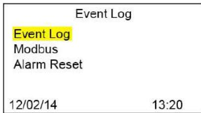
С помощью магнита выберите кнопку Start (Пуск). Для просмотра доступных функций используйте кнопки прокрутки ВВЕРХ/ВНИЗ. Используйте стрелку для прокрутки вниз до функции Event Log (Журнал событий) и нажмите клавишу Select (Выбрать).
