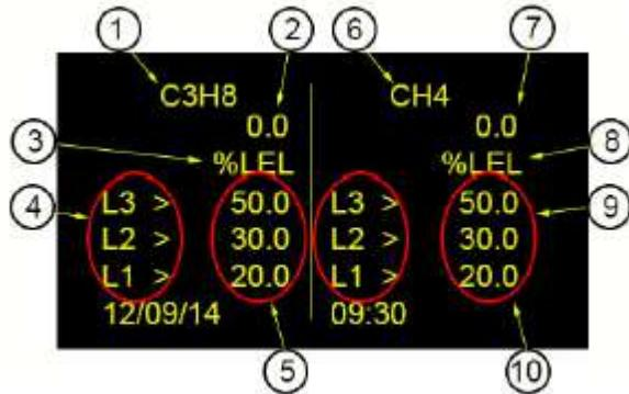
Рисунок 2-5: Двойной дисплей для отображения информации по газу
