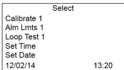
С помощью магнита выберите кнопку Start (Пуск). Для просмотра доступных функций используйте кнопки прокрутки ВВЕРХ/ВНИЗ. Используйте стрелку для прокрутки вниз до функции Set Time (Настройка времени) и нажмите клавишу Select (Выбрать). Появится окно Alarm point (Точка сигнализации).
